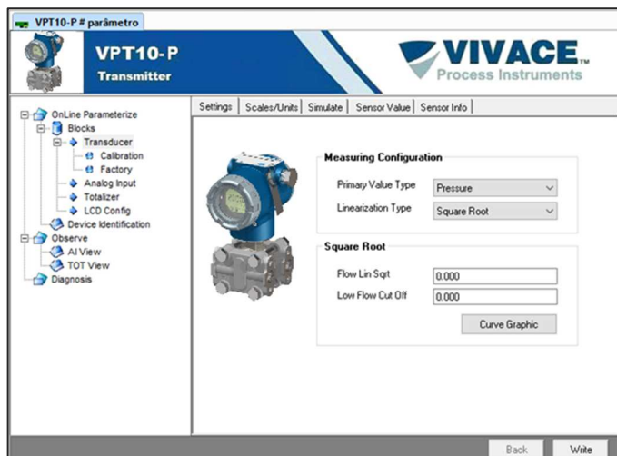
Figura 3.9 – Tela de configuração do VPT10 PROFIBUS.
